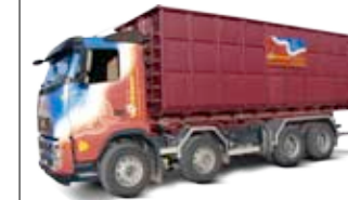
LKW mit Abrollcontainer Nutzlast 17 t Mulden von 15 bis 44 m 3
