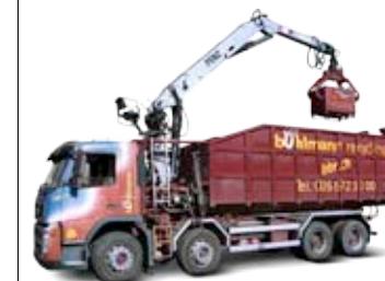
LKW mit Kran und Mulde Nutzlast 11 t Mulde max. 36 m 3
