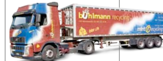
Schlepper mit Auflieger Nutzlast 24 t Inhalt max. 60 m 3
